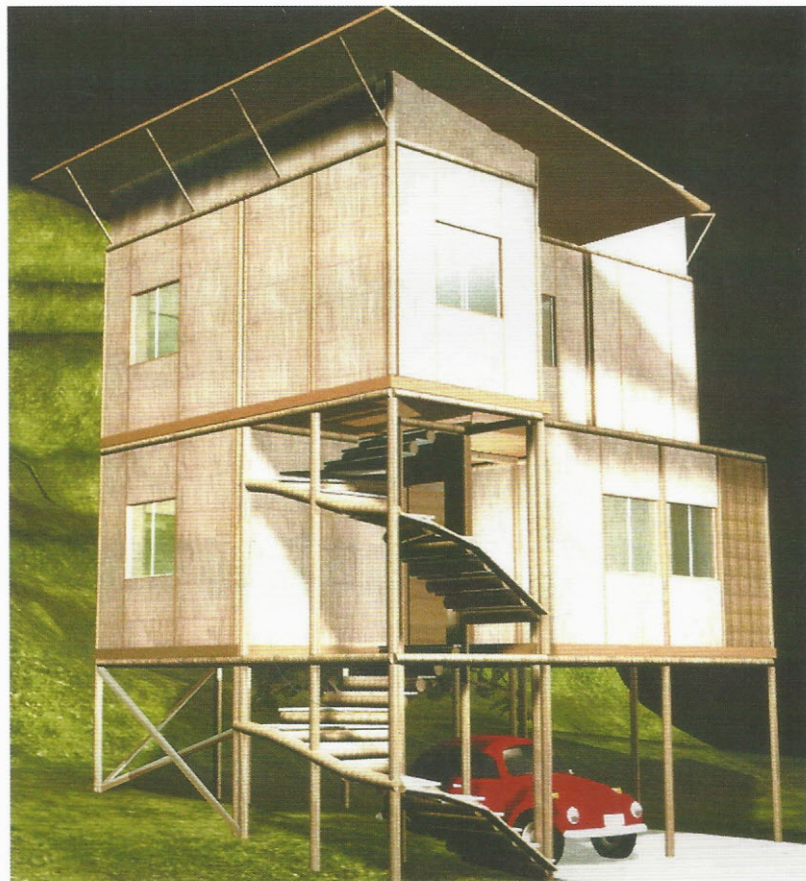
Tipologia para terreno com declividade de 50%
